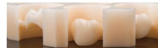
Zirconia precolorata ad alta traslucenza, disponibile in quattro varianti cromatiche che costituiscono la **base ideale per riprodurre il colore del paziente** o come sottostruttura per la stratificazione totale o parziale con ceramica:
